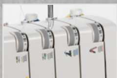
Tydlig kontrollpanel Kontrollpanelen är enkel att använda; färgmarkeringarna gör det lätt att justera trådspänningen.
